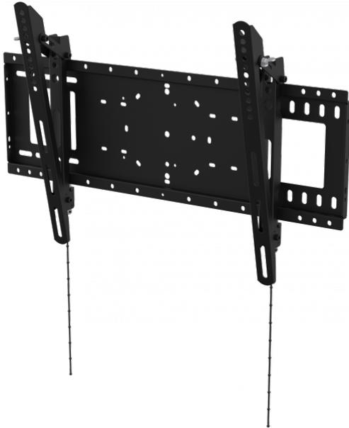
Die **Vision Flachbildschirm Wandhalterungen** werden vom Engineering-Team von Vision für professionelle AV-Monteure entwickelt. Diese Halterung erfordert keine Kompromisse: sehr stabil, schnell zu installieren, hochgradig anpassbar, alles enthalten. Die VFM-W6X4 eignet sich für LCD- oder LED-Flachbildschirme mit rückseitigen Montagebohrungen in einem Abstand von 600 x 400 mm (Breite x Höhe).
